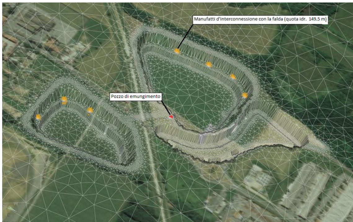
Fig. 11 – Modello 3D relativo alla soluzione di drenaggio post-operam prevista dal Progetto Definitivo
