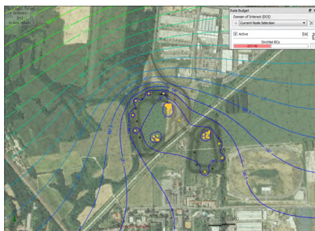
Fig. 9 – Esempio di soluzione “mista” (opzione b) con emungimenti da pozzi e aggettamento da fondo scavo
